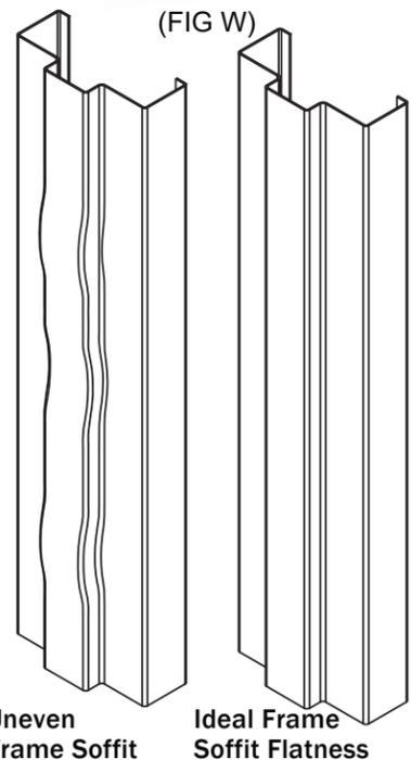
Uneven Frame Soffit
